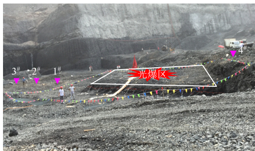
图 19 水平光爆试验中的现场炮孔及测点布置
